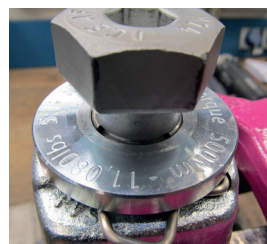
Abb. 14: Sprengring umlaufend vertieft in der Ansenkung positioniert
