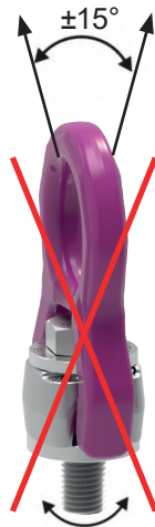
Abb. 11: Verbotene Drehbewegung bei Belastung in Achsrichtung
